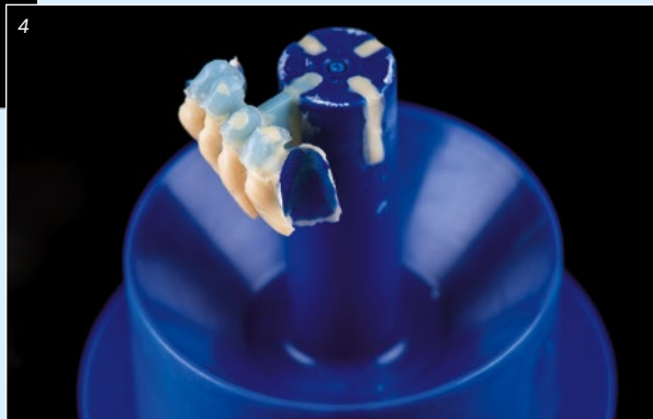
4 In deze situatie maken we gebruik van een multi-layerperstechniek. Hierbij wordt het werkstuk met een rechthoekig perskanaal parallel aan de asrichting van de elementen opgestoken en ingebed.
